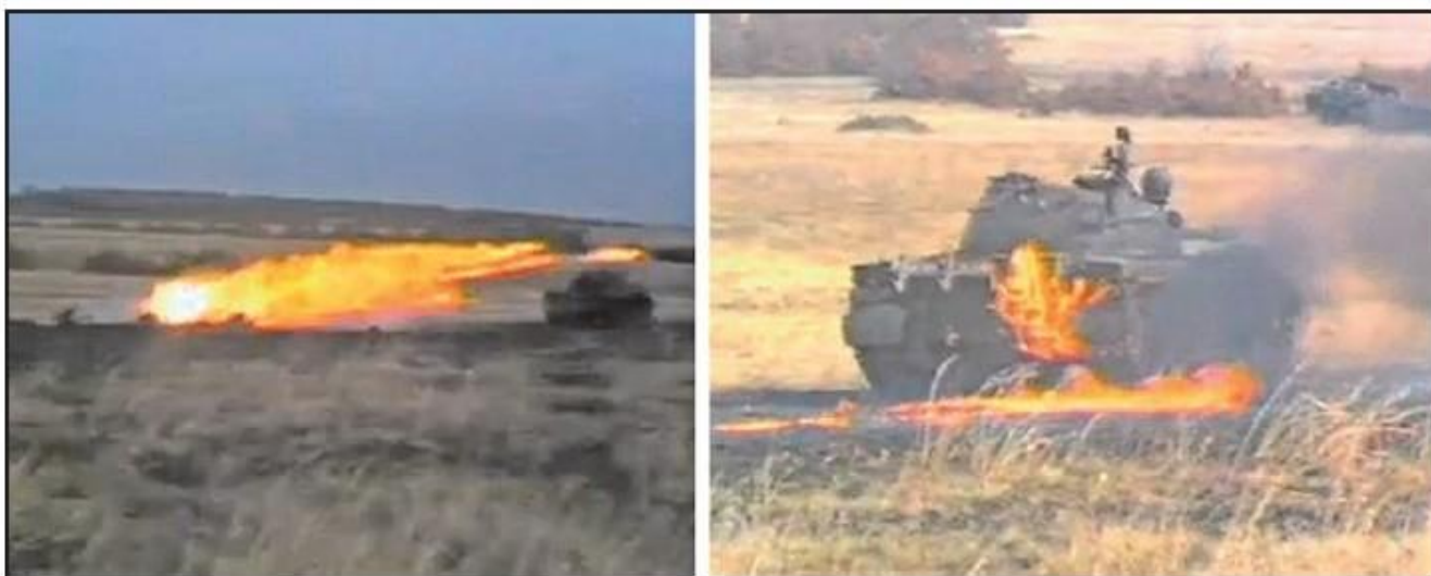
89. ábra. Lövés az LPO-50-es típusú lángszórókkal a harckocsi farpáncéljára, motorterére, és annak hatása
